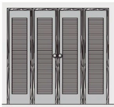
Dvojité skládací žaluziové dveře: větrací plocha 800 cm 2
