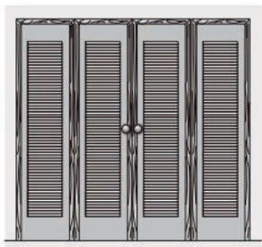
Dvojité skládací žaluziové dveře: větrací plocha 800 cm 2
