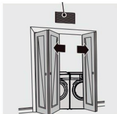
Dvojité skládací plné dveře bez větrání
